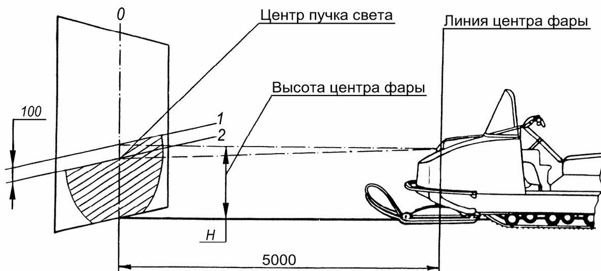
Рисунок 12 – Регулировка фары
