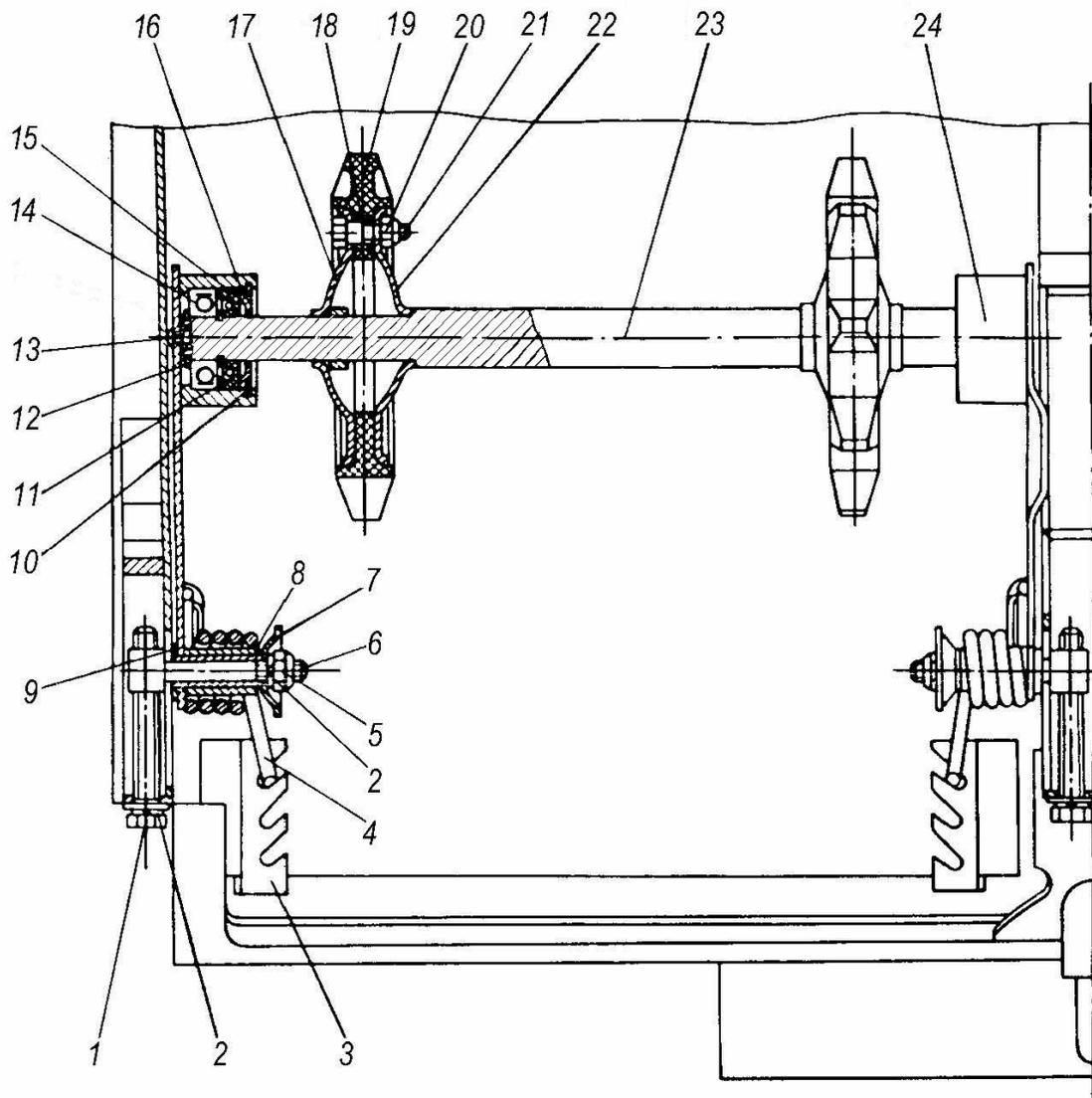
Рисунок 5 – Направляющий вал с механизмом натяжения гусениц
